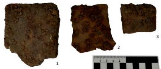
**Abb. 7: Luterseeberg: Eisenkeile aus dem Innenbereich der Kaue (Befund 1.1): Nr. 1: L = 9,9 cm, B = 8,1 cm; Nr. 2: L = 7,8 cm, B = 5,9 cm; Nr. 3: L = 4,9 cm, B = 5,5 cm (Länge: gemessen in Schlagrichtung, Breite: gemessen rechtwinklig zur Länge) (Quelle: CONTEXT OG, 2009).**
