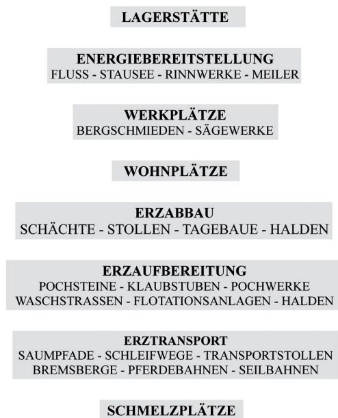
Abb. 3: Vereinfachte Darstellung der Strukturelemente des Bergbauens am Südtiroler Schneeberg, Foto: CONTEXT OG, 2011.
