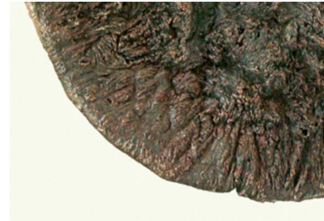
◀ Abb. 5: Oberflächendetail eines im offenen Herdguss gefertigten Gusskuchens.
